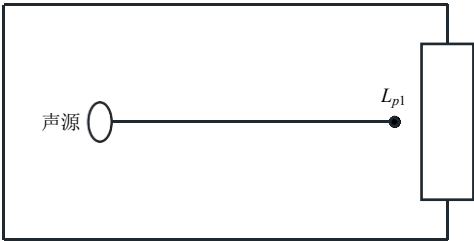
图4-1 室内声源等效为室外声源图例
